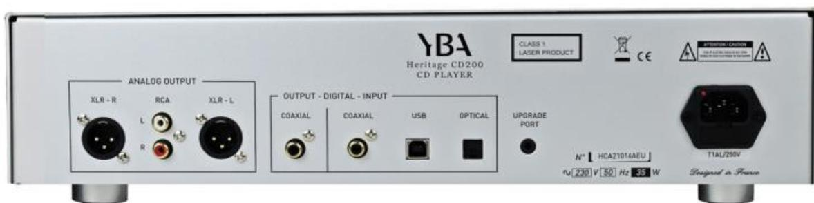
L'arrière du coffret reçoit une double paire de sorties analogiques : XLR et RCA plaquées or. Etant prévu pour fonctionner en mode convertisseur N/A, cette mouture est pourvue d'une entrée numérique coaxiale S/PDIF, d'une entrée optique S/PDIF (compatibles 24 bits / 192 kHz) et d'une entrées USB-B XMOS XU208 (24 bits / 192 kHz, compatible DSD64). Une sortie numérique coaxiale est également présente.
