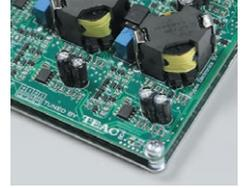
一方、音質に大きく影響するオペアンプには定評あるMUSESを採用。ボリューム回路には左右各チャンネルごとに独立した抵抗ラダー型電子ボリュームを採用して常用域で0.5dBステップという細かなボリューム調節が行えるなど細部にわたってオーディオ専用設計のパーツを採用しました。
